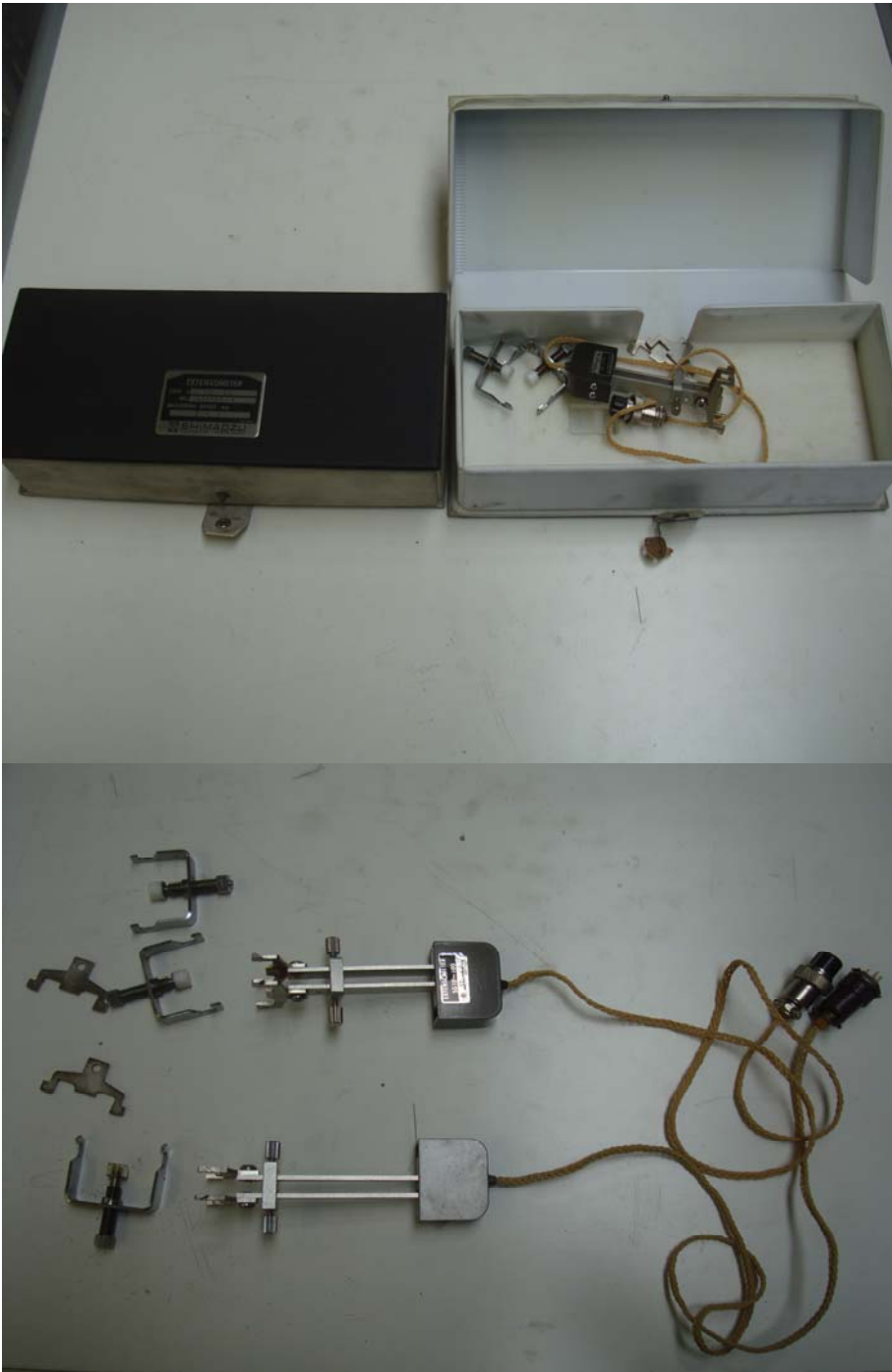
Estensimetri elettronici a strain gauge Bo.= 10 mm corsa max 1 mm
